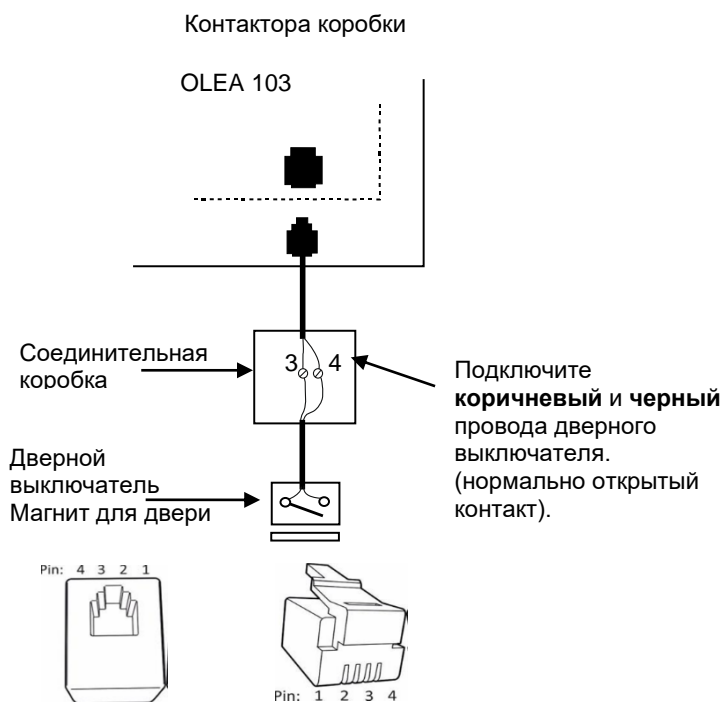
Рисунок 7. Расположение выводов разъема RJ10 печатной платы.
